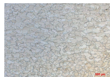
APRÈS TRAITEMENT structure homogène recristallisée
