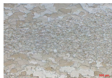
AVANT TRAITEMENT structure hétérogène
