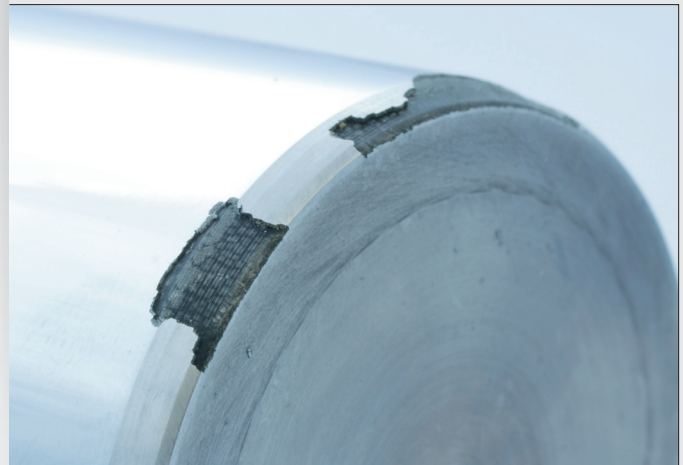
Fig. 2 Cylindre traité par chromage dur avec écaillage provoqué par la contrainte dynamique; ce problème ne se présente pas avec les surfaces traitées par S3P.
