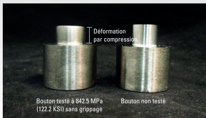
fig. 3 Photo du plots AISI 316 testé à 842.5 MPa (122.2 KSI) résultant en une déformation sous l'effet de la compression; aucun grippage observé.
