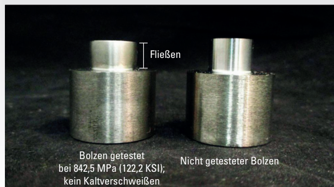
Abb. 3 Abbildung eines bei 842,5 MPa (122,2 KSI) getesteten AISI 316 Bolzens, das in Fließen, aber keinem Kaltverschweißen resultiert.
