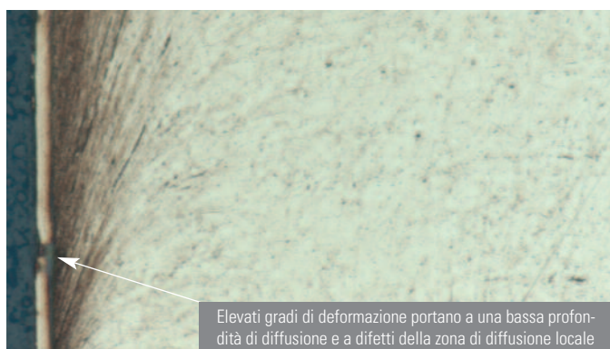
Fig. 5: Componente in acciaio inossidabile con superficie indurita. A sinistra: Superficie punzonata. Superficie irregolare e fortemente deformata (aree scure). Profondità di diffusione ridotta e proprietà anticorrosione compromesse in questa zona. A destra: stessa parte forata invece che punzonata. Una minor deformazione e una finitura superficiale regolare garantiscono una maggior profondità di diffusione e migliori proprietà di corrosione.
