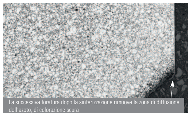
Fig. 6: Sezione trasversale sinterizzata, parti MIM in acciaio inossidabile. La diffusione dell'azoto (area di superficie scura) impedisce la diffusione senza impedimenti e l'elevata durezza superficiale dopo l'indurimento superficiale a bassa temperatura. Una successiva foratura (a destra) rimuove parzialmente la zona di diffusione dell'azoto. Una successiva operazione di foratura (a destra) rimuove parzialmente la zona di diffusione dell'azoto. In quest'area è possibile una diffusione senza ostacoli.
