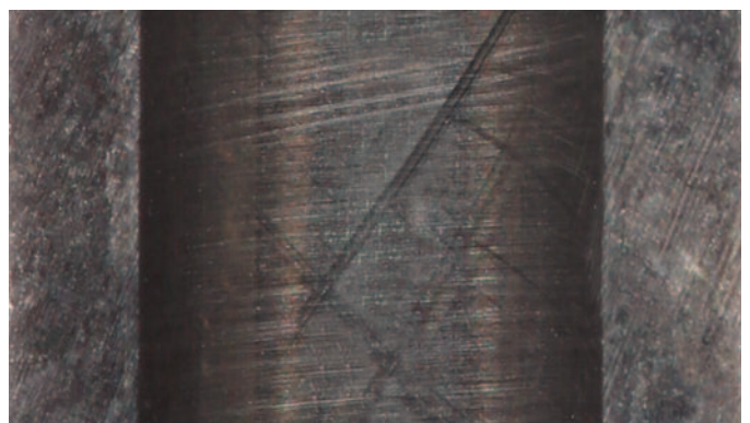
Fig. 4: Superficie in acciaio inossidabile levigato. A destra: Forze di taglio elevate e un utensile usurato hanno come conseguenza una superficie piuttosto deformata che non tagliata. A sinistra: forze basse e un utensile affilato hanno come conseguenza un modello di affilatura ben definito, che è la condizione naturale per operazioni di levigatura corrette. Una minor deformazione, un minor apporto di calore e una minor spalmatura portano a un miglior comportamento di diffusione e ad una miglior resistenza alla corrosione.
