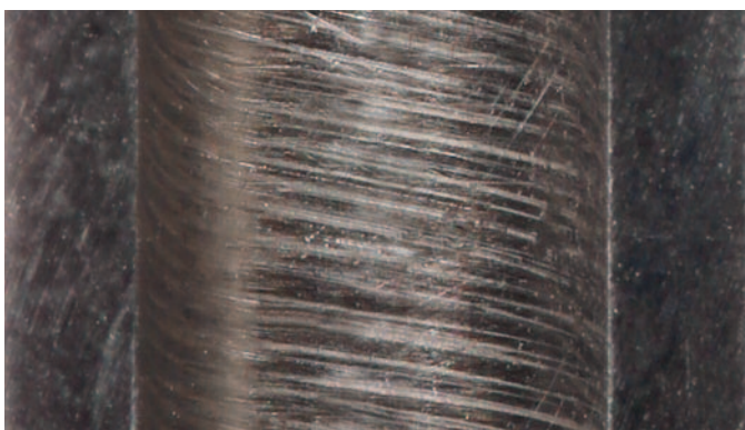
Fig. 4: Superficie in acciaio inossidabile levigato. A destra: Forze di taglio elevate e un utensile usurato hanno come conseguenza una superficie piuttosto deformata che non tagliata. A sinistra: forze basse e un utensile affilato hanno come conseguenza un modello di affilatura ben definito, che è la condizione naturale per operazioni di levigatura corrette. Una minor deformazione, un minor apporto di calore e una minor spalmatura portano a un miglior comportamento di diffusione e ad una miglior resistenza alla corrosione.
