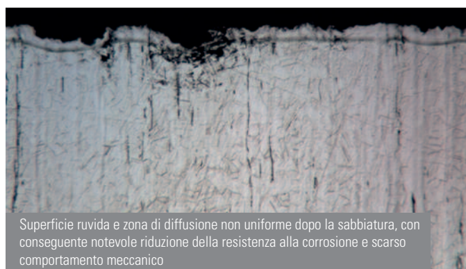
Fig. 3: Confronto dei risultati dell'indurimento superficiale a bassa temperatura per AISI 316L in seguito a elettrolucidatura (a sinistra) e sabbiatura (a destra). La sabbiatura porta a deformazioni locali elevate con eccessiva formazione di martensite da deformazione. La diffusione è ostacolata e la resistenza alla corrosione è ridotta. A confronto, le superfici elettrolucidate creano una zona di diffusione omogenea e priva di difetti.
