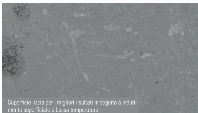
Fig. 2: Superficie in acciaio inossidabile dopo la vibrofinitura. A sinistra: superficie liscia (Ra 0.17) con piccoli difetti, ottenuta con parametri regolati e abrasivi morbidi. A destra: finitura superficiale grossolana (Ra 0.56), inclusioni abrasive ed eccessiva formazione di martensite da deformazione, che porta ad un cattivo comportamento alla corrosione e alla diffusione.
