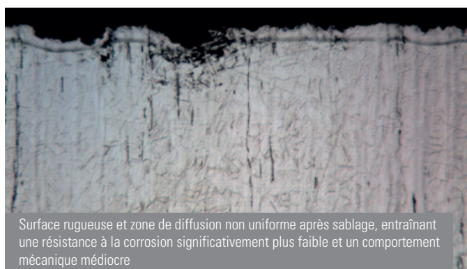
Fig. 3: Comparaison des résultats de LTSH pour un acier AISI 316L après électropolissage (à gauche) et sablage (à droite). Le sablage entraîne d'importantes déformations locales, avec formation excessive de martensite d'écrouissage. La diffusion est entravée et la résistance à la corrosion diminue. En comparaison, les surfaces traitées par électropolissage présentent une zone de diffusion homogène et exempte de défauts.
