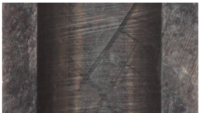
Fig. 4: Surface d'acier inoxydable tourné. Droite: Avec une force de coupe élevée et un outil usé, la surface est plus déformée que coupée. Gauche: avec une force peu importante et un outil acéré, l'aspect obtenu est naturel pour un meulage correct. Avec moins de déformation, d'apport thermique et de souillage, le comportement de diffusion et la résistance à la corrosion sont améliorés.
