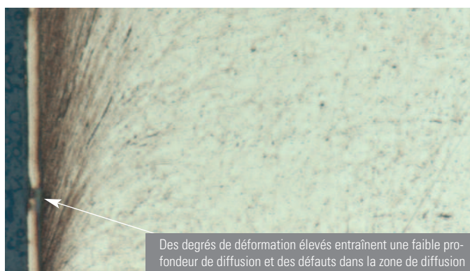
Fig. 5: Composant en acier inoxydable à surface durcie. Gauche: Surface poinçonnée. Surface irrégulière et fortement déformée (zones sombres). Dans cette zone, la profondeur de diffusion est réduite et les propriétés de corrosion sont altérées. Droite: la même pièce, alésée plutôt que poinçonnée. Les déformations moins importantes et l'état de surface régulier permettent une profondeur de diffusion plus importante et une amélioration des propriétés de corrosion.
