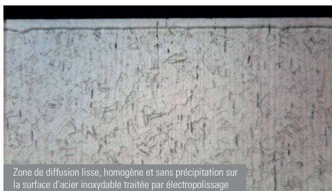
Fig. 3: Comparaison des résultats de LTSH pour un acier AISI 316L après électropolissage (à gauche) et sablage (à droite). Le sablage entraîne d'importantes déformations locales, avec formation excessive de martensite d'écrouissage. La diffusion est entravée et la résistance à la corrosion diminue. En comparaison, les surfaces traitées par électropolissage présentent une zone de diffusion homogène et exempte de défauts.
