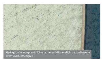
Abb. 5: Oberflächengehärtetes Edelstahlbauteil. Links: Gestanzte Oberfläche. Unregelmäßige und stark verformte (dunkle Bereiche) Oberflächen. Geringere Diffusionstiefe und beeinträchtigte Korrosionseigenschaften in dieser Zone. Rechts: gleiches Teil gebohrt statt gestanzt. Weniger Verformung und gleichmäßige Oberflächenbeschaffenheit führen zu einer höheren Diffusionstiefe und verbesserten Korrosionseigenschaften.
