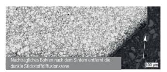
Abb. 6: Querschliff gesinterter MIM-Teile aus Edelstahl. Die Stickstoffdiffusion (dunkle Oberfläche) verhindert eine ungehinderte Diffusion und hohe Oberflächenhärte nach NTOH. Ein nachfolgender Bohrvorgang (rechts) entfernt die Stickstoffdiffusionszone teilweise. In diesem Bereich ist eine ungehinderte Diffusion möglich.
