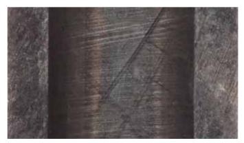
Abb. 4: Geschliffene Edelstahloberfläche. Rechts: Hohe Schnittkräfte und ein verschlissenes Werkzeug führen zu einer Oberfläche, die eher umgeformt als geschnitten ist. Links: Geringe Kräfte und scharfes Werkzeug führen zu einem ausgeprägten Schleifbild, was für die korrekte Honbearbeitung selbstverständlich ist. Weniger Umformung, Wärmeeintrag und Schmierung führen zu einem besseren Diffusionsverhalten und verbesserter Korrosionsbeständigkeit.
