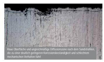
Abb. 3: Vergleich der NTOH-Ergebnisse für AISI 316L nach dem Elektropolieren (links) und Sandstrahlen (rechts). Das Sandstrahlen führt zu lokal hohen Verformungen mit übermäßiger Bildung von Umformmartensit. Die Diffusion wird behindert und die Korrosionsbeständigkeit wird verringert. Im Vergleich dazu führen die elektropolierten Oberflächen zu einer fehlerfreien und homogenen Diffusionszone.
